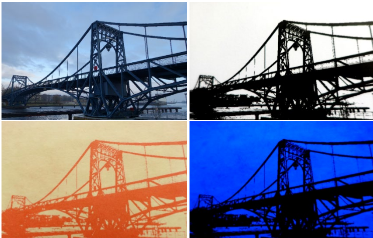
Abb.: Von links oben nach rechts unten: Originalfoto, Ausdruck als Schwarz-Weiß-Bild auf Folie, mittels Diazotypie erhaltenes Bild, dasselbe Bild unter UV-Licht (Motiv: Kaiser-Wilhelm-Brücke in Wilhelmshaven/Deutschland)
