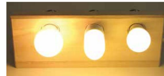
Nun stellt man den Eingang auf AC (Wechselspannung) und erhöht die Empfindlichkeit des Oszilloskops. Wir erfassen jetzt die Schwankung der Helligkeit. Die am Schirm entstehenden Kurven sind bei den drei Lampen deutlich verschieden.
