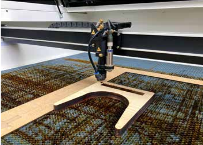
Abbildung 1b: Laserkopf mit Werkstück (nicht im Betrieb, ohne Laserstrahl)
