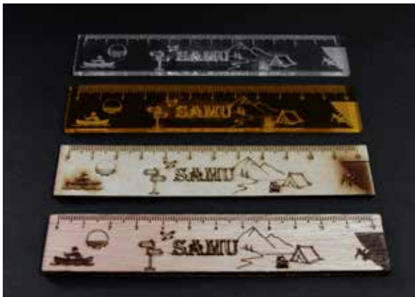
Abbildung 2: Lineal aus dem Werkstoff Acryl (transparent), Acryl (orange), Kraftplex unten mit optimierten Einstellungen und Pappelschichtholz (v.o.n.u.)
