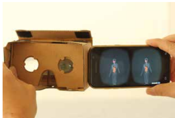
Abb. 4. Bei der Cardboardtechnologie wird der stereoskopische Raumeindruck durch die Kombination einer Smartphone-App mit Split-Screen-Modus und eines Pappkartons mit zwei getrennten Einblicken erzeugt.
